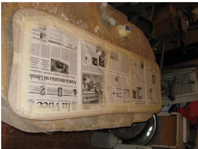
Copriamo accuratamente la carena, inseriamo le viti nelle boccole straps/maniglia.....
