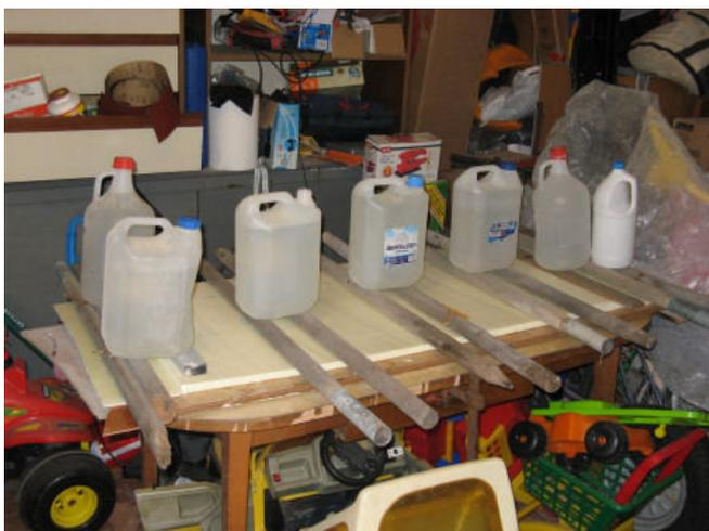
Si procede ora all'incollaggio del legno con l'espanso. Per dare il rocker alla tavola ho usato un piano in compensato da 2cm opportunamente curvato con l'ausilio di morsetti e spessori. Ho sistemato il legno sul piano curvo, ho steso uno strato di Vinavil sul legno, ci ho adagiato sopra l'espanso e ho messo un pò di pesi sopra per far aderire bene il tutto (oltre a quelli in foto ne ho aggiunti altri)
